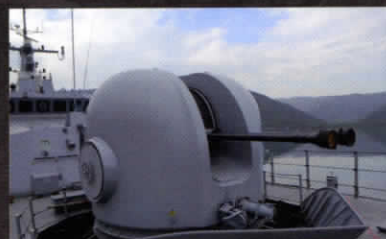
船首に配置された、主砲のOTOメララ40 / 70コンパクト40mm 連装砲。発射速度は毎分600発。水上、沿岸目標の他、限定的な 対空能力も有する
