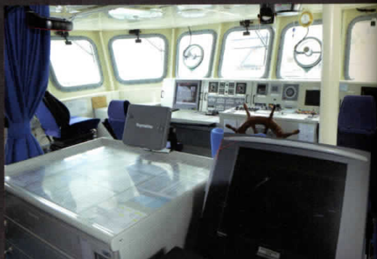
「キョイジェーイス」の航海艦橋。トズラ級は、インテグレートド・ブリ ッジ・システムにより、最小わずか3名で運用できる
