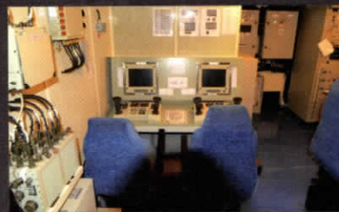
12.7mm STAMP安定化機関銃用、多機能コンソール。というか まるでTVゲームのコントローラーの趣だ。機関銃は完全に無人で、 艦内からIR映像により照準、射撃される
