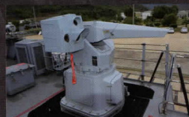
12.7mm STAMP安定化機関銃。リモートコントロール式で銃座は 安定化されており、不審船舶等水上の小目標にたいして使用され る。左右に2基が装備されている
