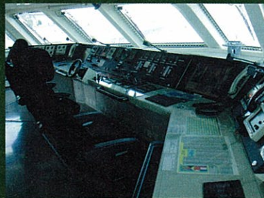
まるで大型機のコックピットのような航海艦橋。最近の艦艇の例にもれず、自動化、ハイテク化が図られている。ウインドガラスはレーダー反射対策で金属被膜が付加されている
