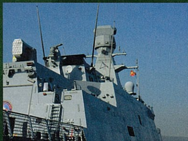
後下方より見たヘイベリアダの上部構造物およびレーダーマスト。格納庫上にはRAM発射機が見える
